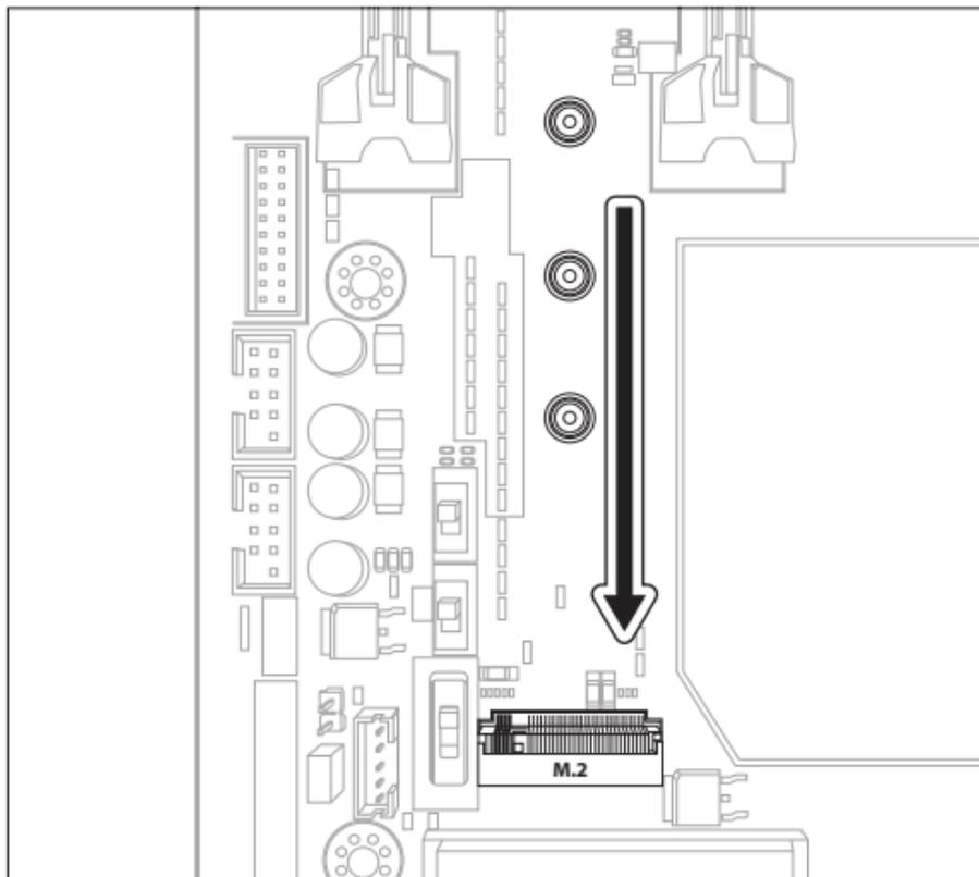
图 1：显示 M.2 插孔，带 M.2 支架 2242、2260 和 2280 螺钉孔。
