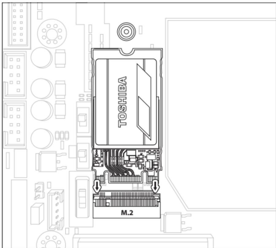
图 2 : 将 Toshiba NVMe SSD 插入 M.2 插孔
