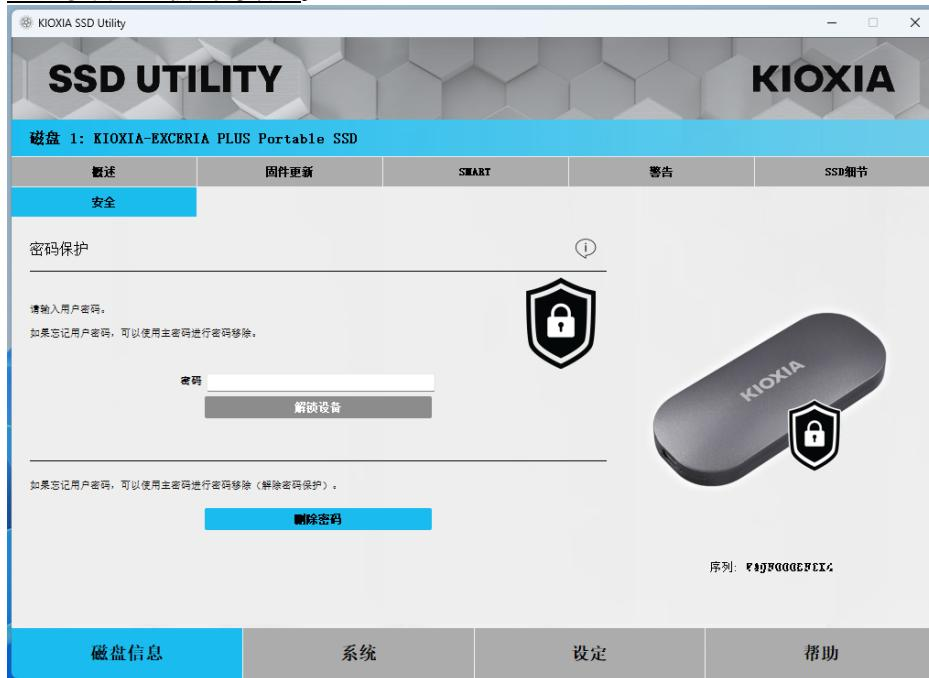
如果没有显示黑色盾牌图标 , 请在 “ 选择硬盘 ” 窗格中选择 “ KIOXIA-EXCERIA PLUS Portable SSD ” , 然后选择 “ 安全 ” 选项栏。即使没有执行 “ 解锁装置 ” 操作却显示如下图的解锁成功后的模块 , 并显示 “ 删 除密 码 ” 按钮 , 则表示设置的密码保护可能不正确。在这种情况下 , 请点击 “ 删 除密 码 ” 按钮移除密码 , 然后再次尝试执行 “ 设置密 码 ” 操作。
